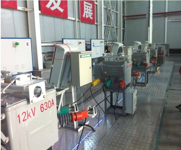
电压-时间型馈线自动化其特点为不依赖通信和后台建设，同时组网简单，维护简单，后期增加通信及后台时原有设备无需较大改造。
