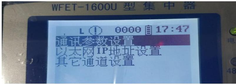
(5) 操作上下左右键调整密码为“000000”，操作左右键使光标停于“OK”处，点击“确认”键。若提示错误则重新输入“111111”即可，因为本套设备所有电表设置的密码只有“000000”和“111111”两种。
